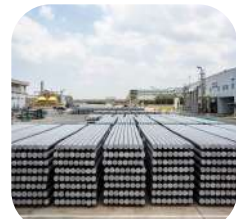
不要部分を切断、全長6.3mのビレットが完成
